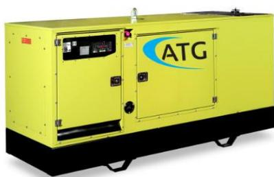
エンジン/交流機 柔軟性のあるディスク連結を通じ結合した一体鋳造型ユニット、溶接による鋼鉄基礎枠組への設置、土台部位振動対策を完備。15/10 鋼板ドア付き防音筐体、防音素材、内部サイレンサー、鋼鉄製の取っ手と蝶番、鍵付きの外部燃料タンクキャップ、吊り上げフック、RAL 1004 (明るい黄色) のパウダー塗装。
